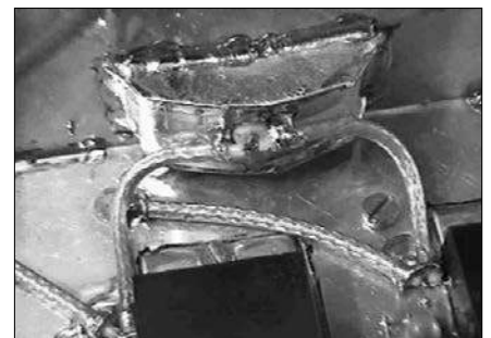
Fig. 2 en 3 Detailfoto's van de stub-bevestiging en de afscherming van de 50 Ohm-weerstand
