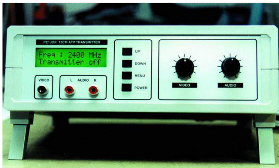
Figuur 1: Een gebouwd exemplaar van de 13 cm ATV-zender
