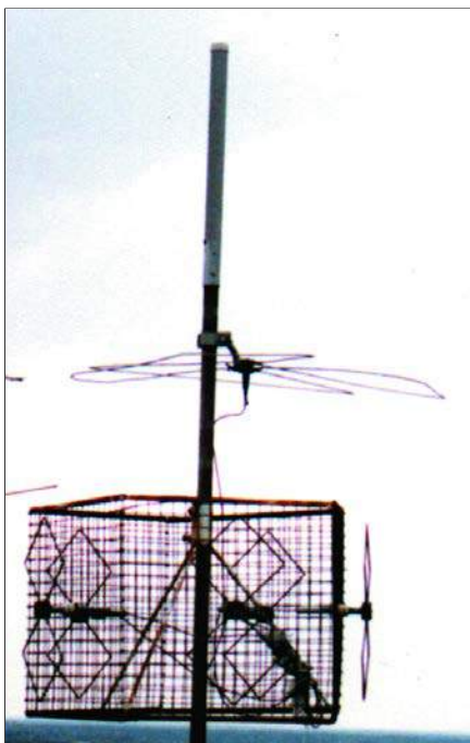
Figuur 1 en 2: Het antennepark van PI6EHV heeft na de verhuizing naar het ziekenhuis al diverse veranderingen ondergaan. Rechts de huidige situatie, de 70 cm dubbelquad's zijn vervangen door een klaverblad en nieuw zijn de antenne's voor 13 en 3 cm.
