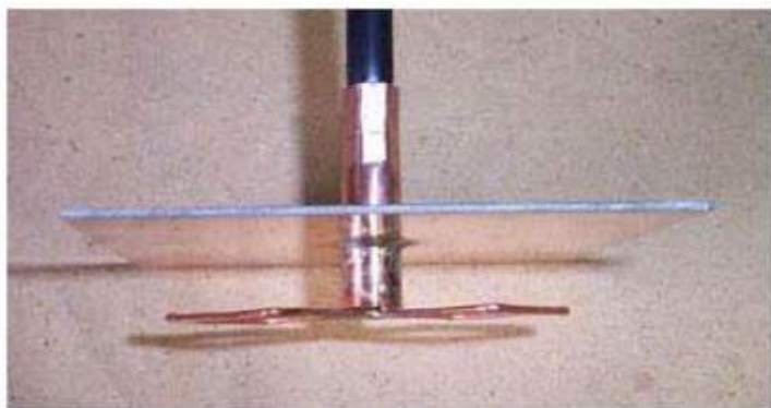
Een compleet gebouwde antenne
