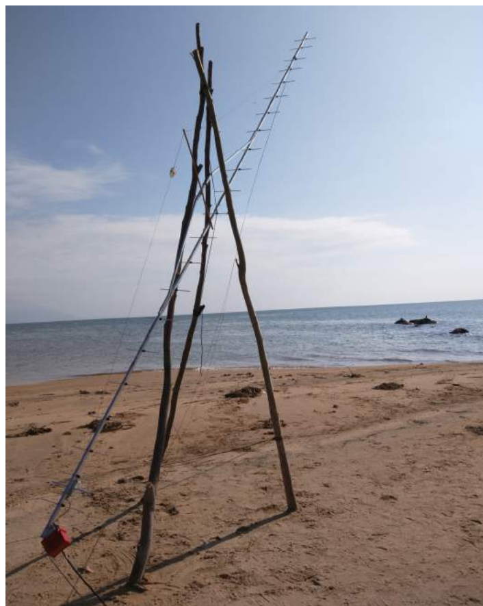
Op 70cm een 23 elements Yagi.
