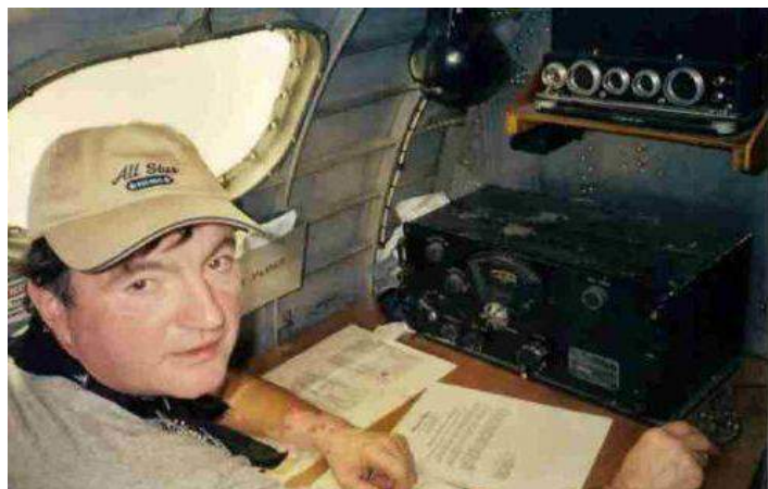
Radio Operator Position in een Boeing B14 (BC 348 Receiver)
