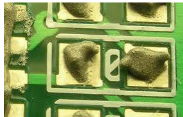
soldeer 'dots' opgebracht met dispenser
