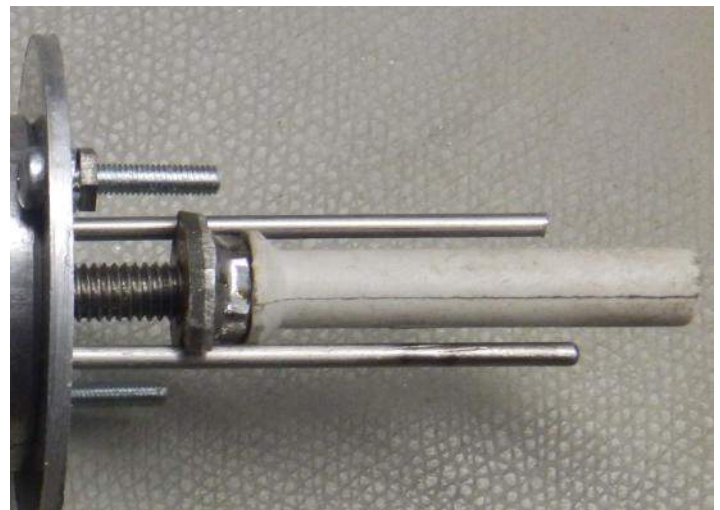
Kunststof aandrukbus (Fischer muurplug) op moer en spindel gemonteerd
