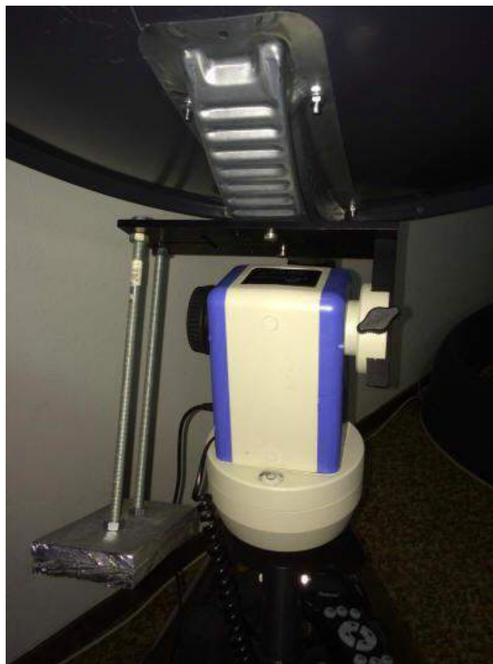
Mechanische constructie om de schotel aan de gearbox te bevestigen .
